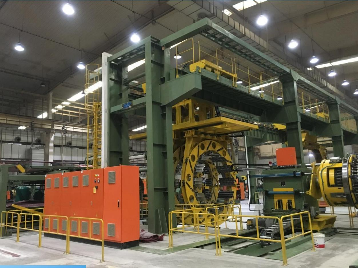
适用于生产20吨~63吨范围内全钢乘用轮胎、全钢轻卡轮胎及全钢工程轮胎。
